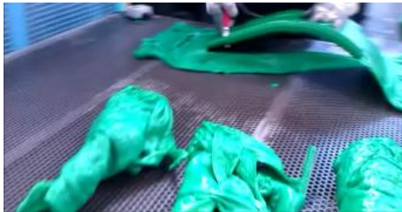
Figura 1: Recorte de rebabas con cuchilla.
