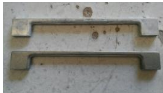
Figura 5. Detalle piezas inyectadas antes y después del vibrado.
