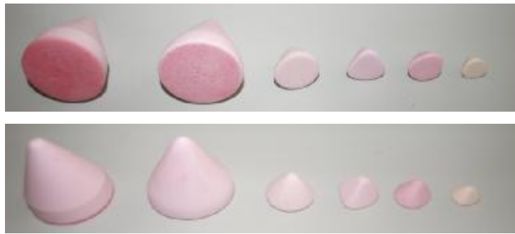
Figura 9. Detalle del desgaste paulatino en moletas/chips de urea.
